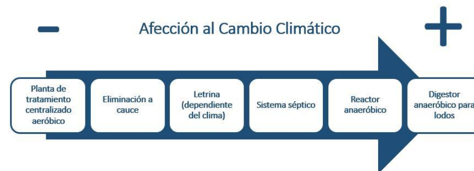
Figura 69. Impacto sobre el cambio climático de los distintos tipos de sistemas de tratamiento de aguas residuales
