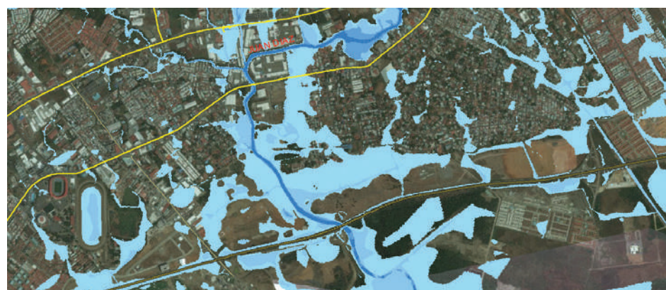
EJEMPLO DE INUNDACIÓN EN LA ZONA DE JUAN DÍAZ EN LA QUE SE APRECIA EL EMBALSAMIENTO DE AGUA EN CIUDAD RADIAL POR EFECTO DEL CORREDOR SUR Y DE LOS RELLENOS DE HUMEDALES.
