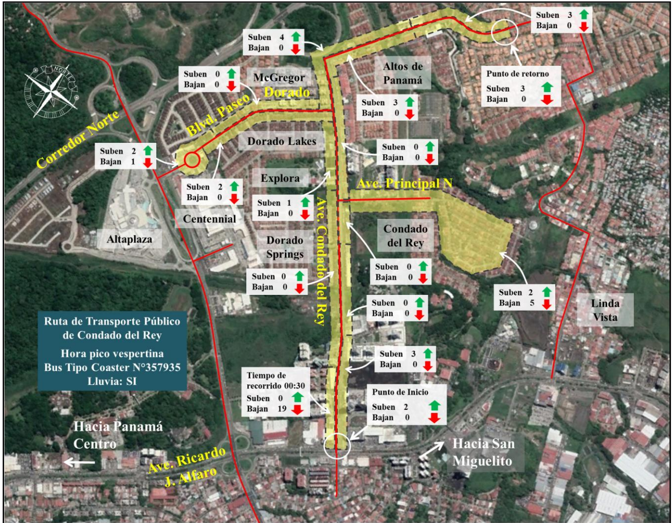
Figura 16. Esquema de los resultados de ascenso y descenso de pasajeros durante la hora pico vespertina, para el bus tipo coaster.
