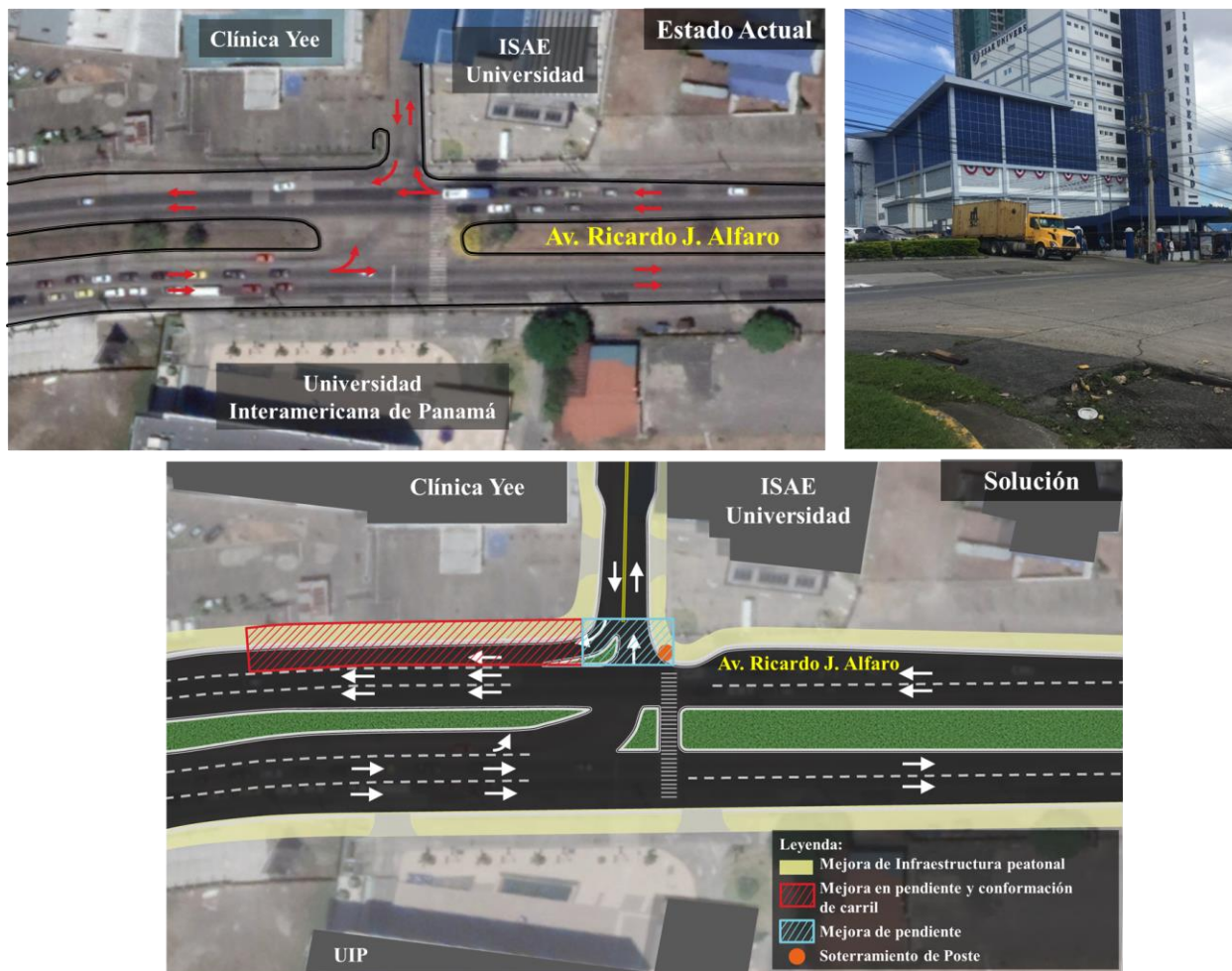
Figura 46. Mejoras propuestas para la intersección de la Av. Ricardo J. Alfaro con Linda Vista.
