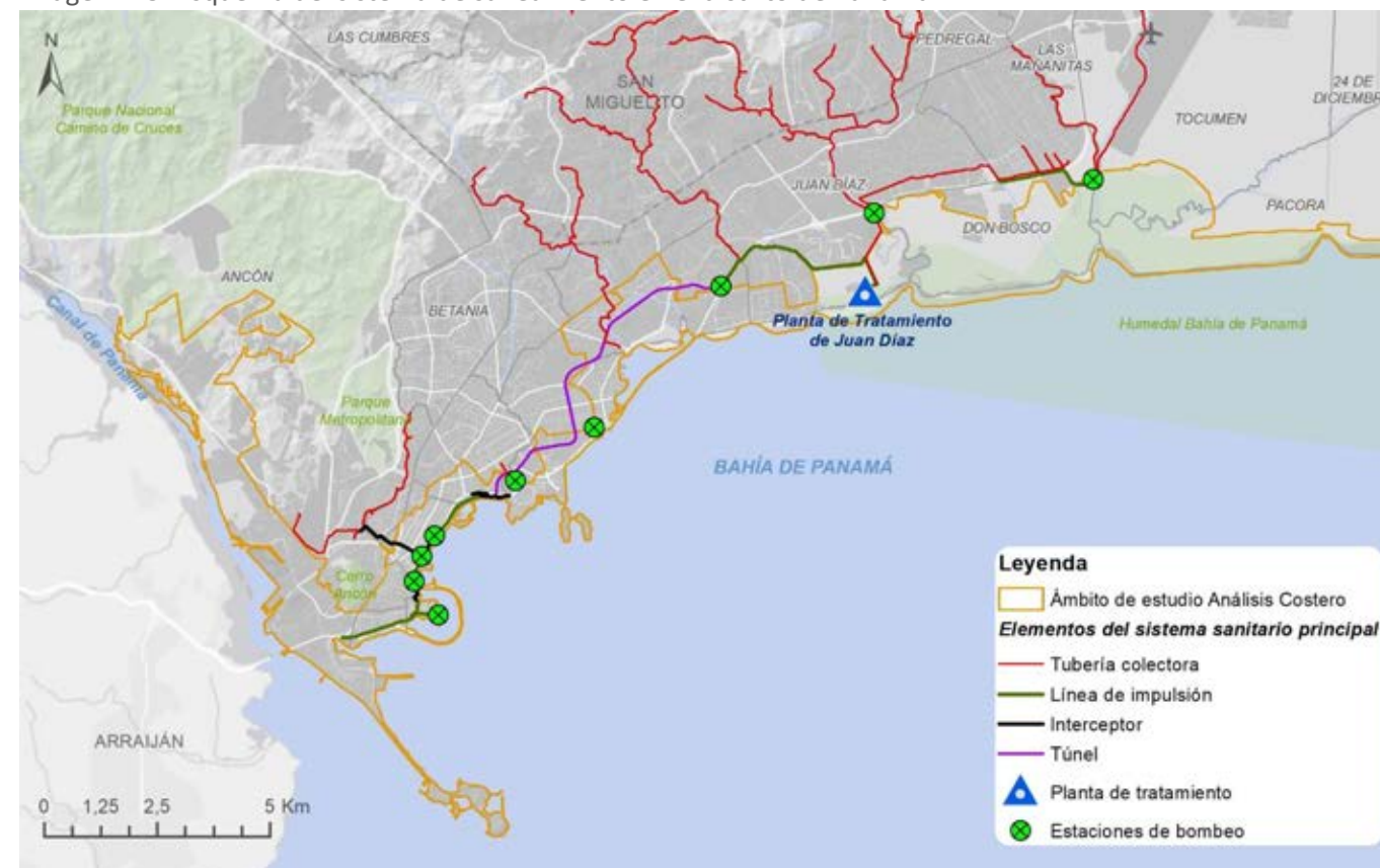
Imagen 179. Esquema del sistema de saneamiento en el distrito de Panamá
