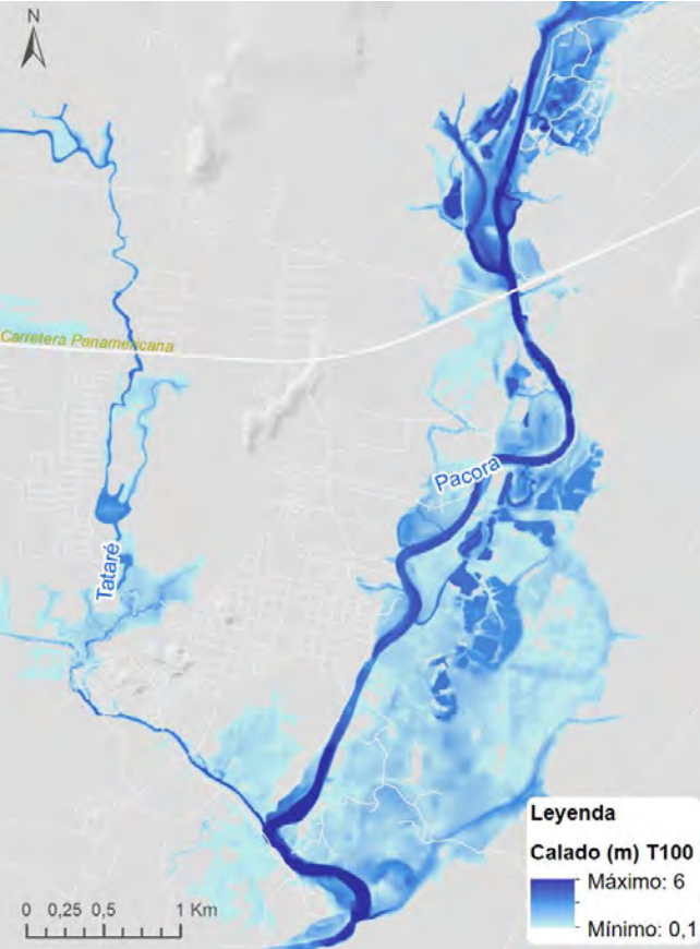
Imagen 147. Detalle del modelo de Inundación ampliado en los ríos Pacora y Tataré
