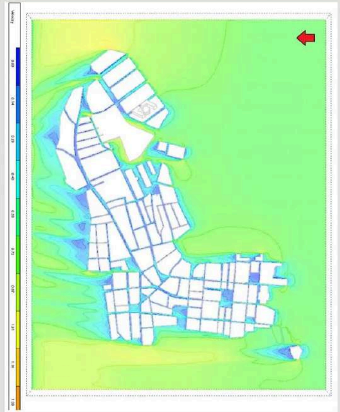
Figura 7. Corte de velocidades a 1.5 m de altura. Imagen producida por medio de la simulación CFD en Design Builder. Fuente: Llam, 2016
